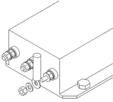
**3. 相线连接** 取下滤波器相线螺栓上的螺母垫片各 1 只，将接好线的端子依次安装在相线螺栓上。注意各端子连线应尽量保证平行。避免交叉
