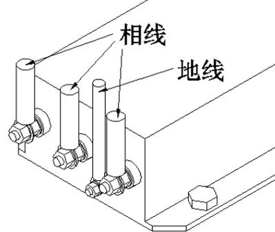
**5. 检查** 在通电之前检查滤波器各个位置的连接及安装情况。特别注意接地线的连接。检查无误后即可加电运行。
