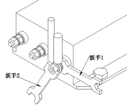
**4. 紧固螺栓** 紧固螺钉时应先用扳手 1 固定住根部螺母，再用扳手 2 拧紧螺母（如图；否则可能导致滤波器端子损坏）。其它各相接方法相同。
