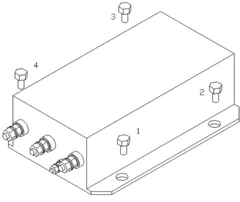
**1. 固定** 将安装螺栓穿过滤器四个安装孔，安装至支架或机箱内，并拧紧螺母固定。
