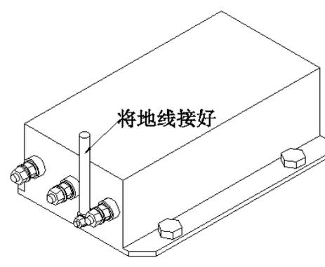
**2. 接地** 将接地螺钉以截面积  $0.5\text{mm}^2$  以上、长度小于 20cm 米的软线与大地连接。
